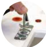
Visser la vis de réglage dans la fente jusqu'à ce qu'il y ait suffisamment de tige à l'intérieur de l'incubateur pour accepter la gaufrette.
